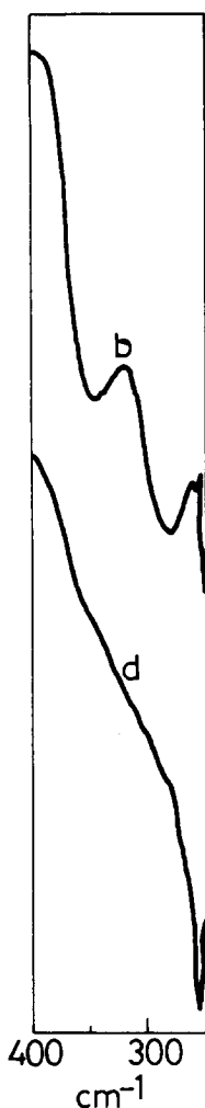
FIG. 4. Cation-oxygen stretching bands for: (b) \text{Ca}_5\text{Sr}_5(\text{PO}_4)_6(\text{OH})_2 , (d) \text{Ca}_5\text{Sr}_5(\text{PO}_4)_6\text{F}_2 .
